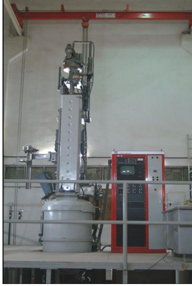
شكل (٣-١٠): جهاز الانماء البلوري (Puller)
