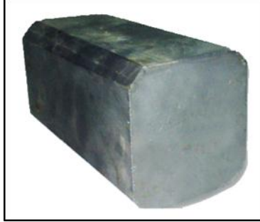
شكل (٣-١٢): بلورة السيليكون بعد تحويلها الى متوازي مستطيلات.
