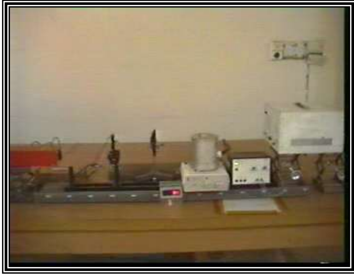
الشكل (6-3) صورة منظومة توليد التوافق الثاني من خلال تغير درجة حرارة بلورة
