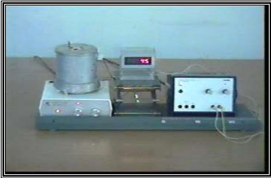
الشكل (3-10) صورة الفرن الكهربائي مع مقياس درجة الحرارة ومجهز القدرة .
