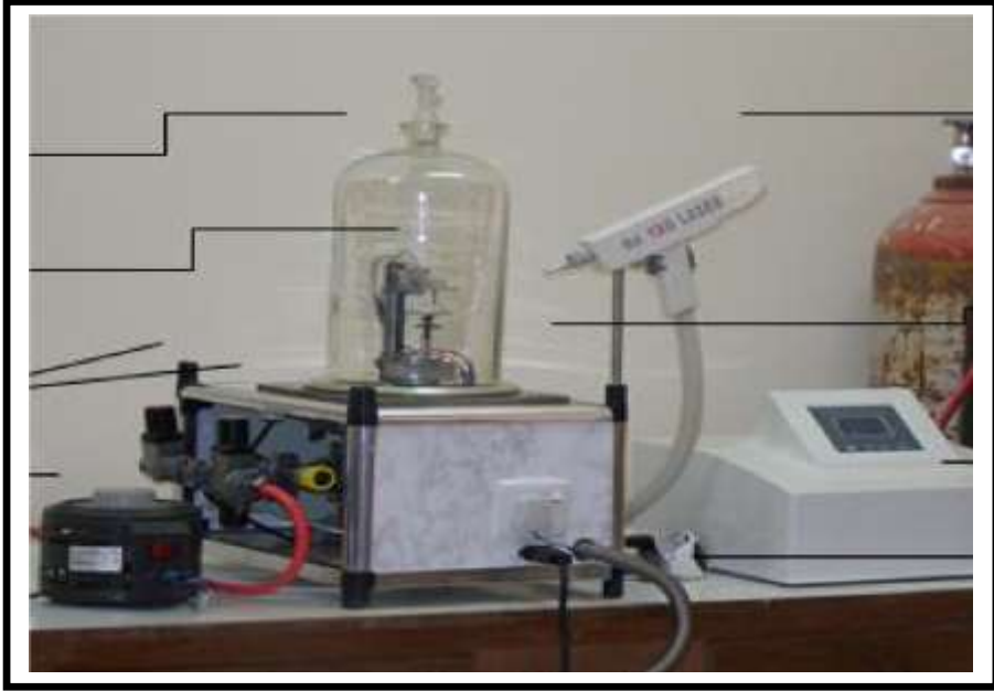
الشكل (٥-٤) صورة فوتوغرافية لمنظومة الترسيب بالليزر النبضي.
