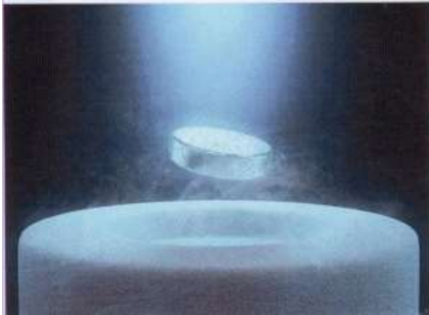
الشكل (٣-٧) يمثل ظاهرة الطفو في المواد فائقة التوصيل
