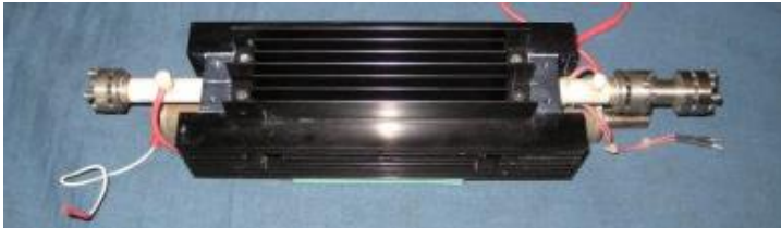
1-14:ليزر ثاني اوكسيد الكربون من نوع موجه الموجة Wave Guide يعطي قدرة تصل الى عشرة واط ، على الرغم من ان طوله لا يتجاوز 30 سم.
